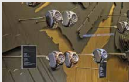
Uhrenhalterungen und Beschriftungsschilder erstellt im 3D Druck Verfahren
